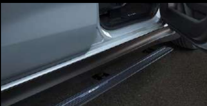
บันไดข้างไฟฟ้าอัตโนมัติ
